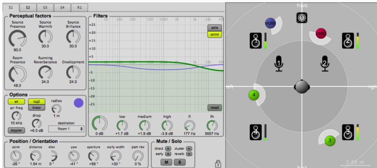
Figure 12 : Le logiciel SPAT, l'interface : Facteurs perceptifs de contrôle de l'effet de salle (gauche) ; filtrages (centre) ; représentation schématique 2D de la scène sonore (droite), CARPENTIER, 2018 [29].
